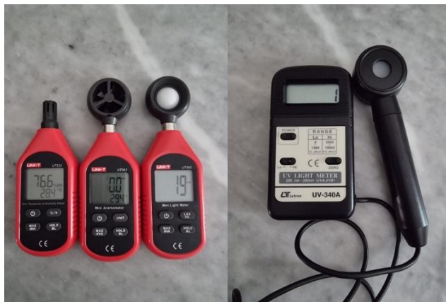
Gambar IV.3. Alat Pengukur suhu ( termometer ), kelembapan udara ( hygrometer ), kecepatan angin ( anemometer ), dan UV Meter
